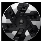
16" x 6,5" Ocelová kola Standardně pro E-Transit Custom Trend
